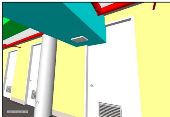
Figura 21. Interferencia de redes BIM del CCP
