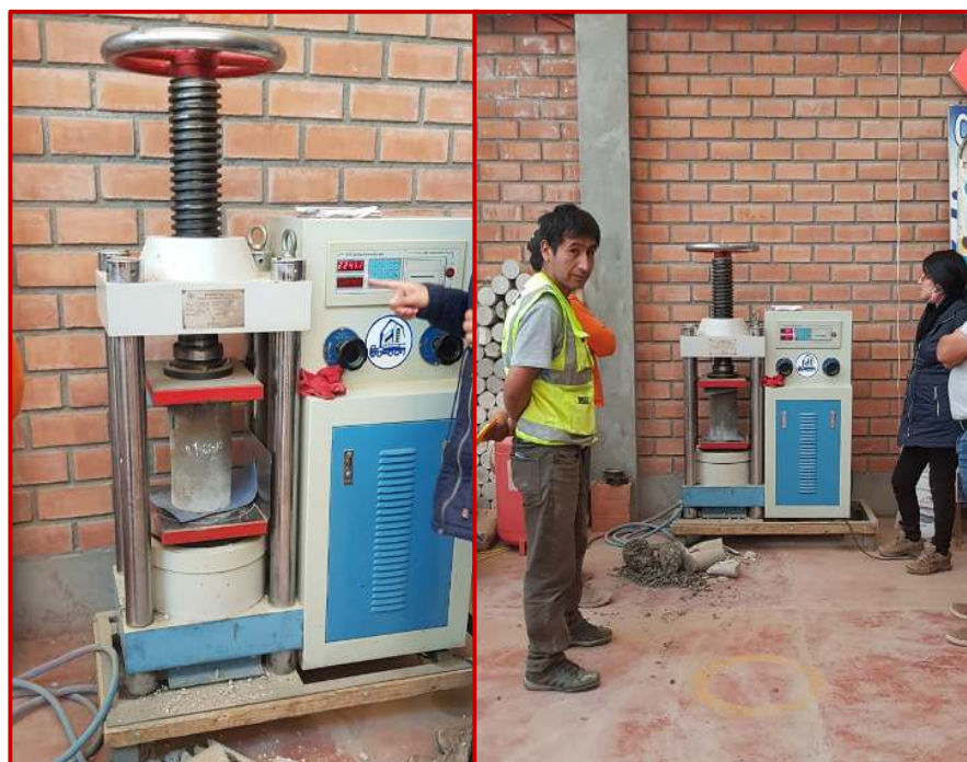
Figura 32: Ensayo de resistencia a la compresión de los testigos
