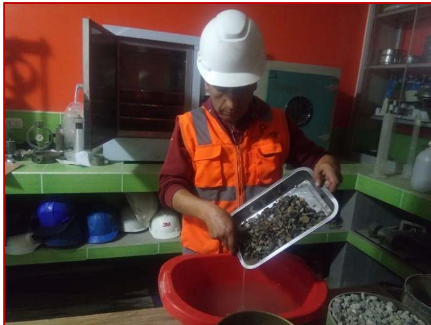
Figura 25: Obtención del porcentaje de absorción del agregado grueso
