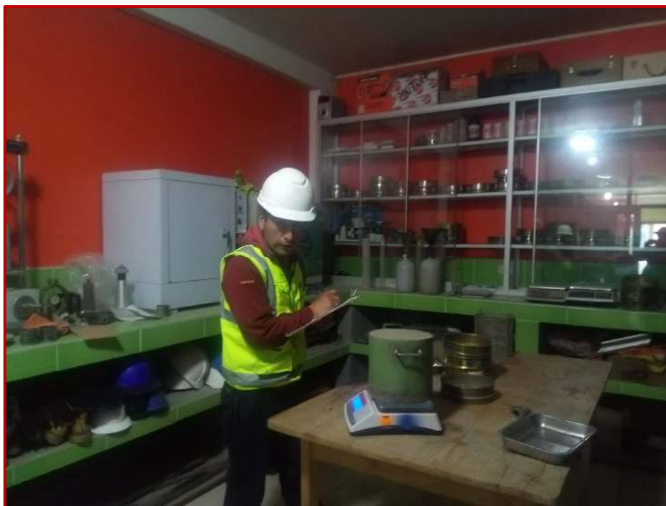
Figura 23: Obtención del peso saturado superficialmente seco
