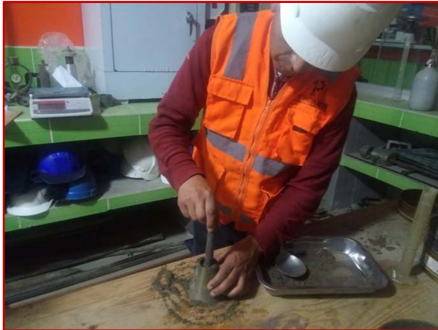
Figura 24: Obtención del porcentaje de absorción del agregado fino.
