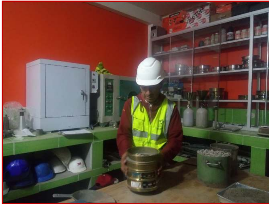
Figura 20: Tamizado de los agregados fino y grueso
