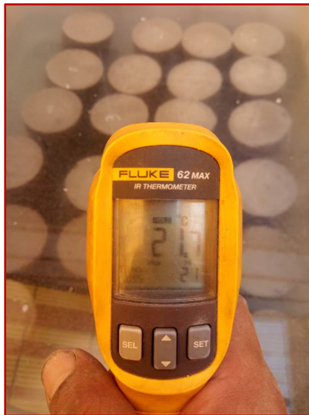
Figura 29: Control de temperatura del curado
