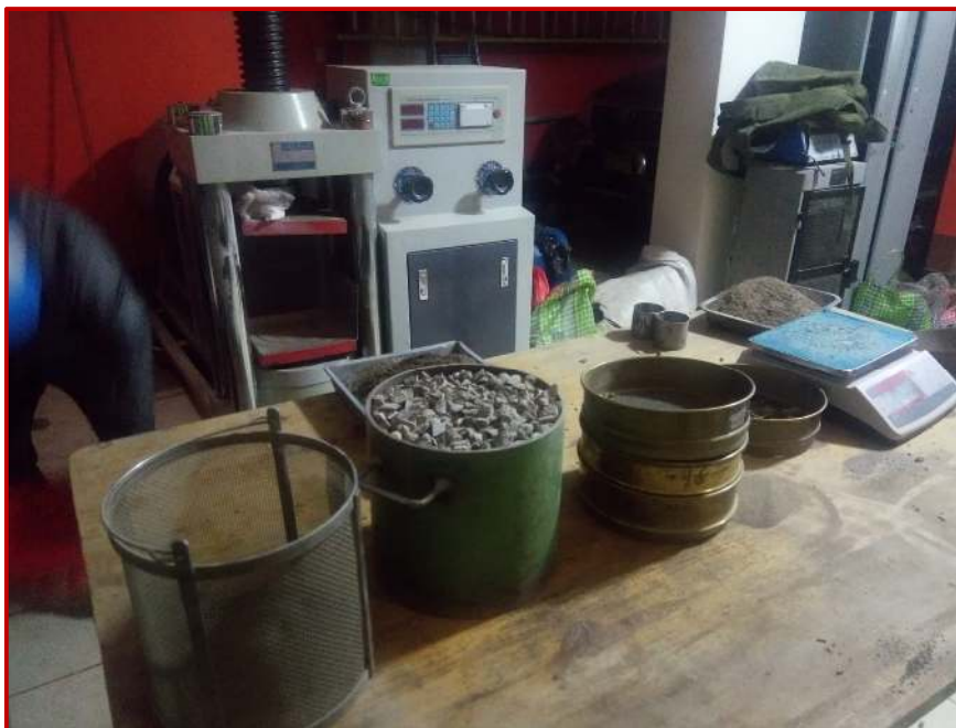
Figura 19: Tamizado de los agregados fino y grueso
