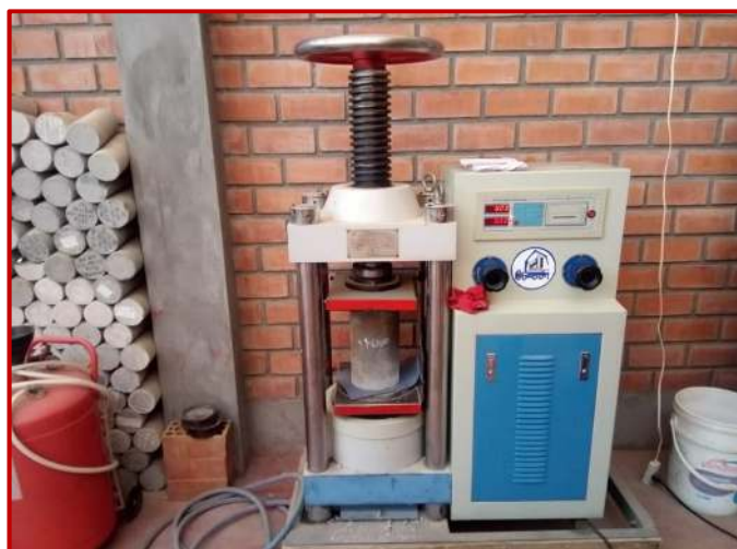
Figura 31: Ensayo de resistencia a la compresión de los testigos
