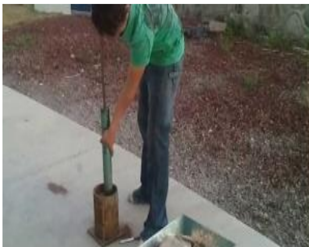
Figura N.º 39 Compactado con el martillo durante el ensayo.
