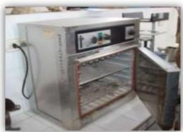
Figura N.º. 35 Horno para el secado de muestras contenidas en las taras.
