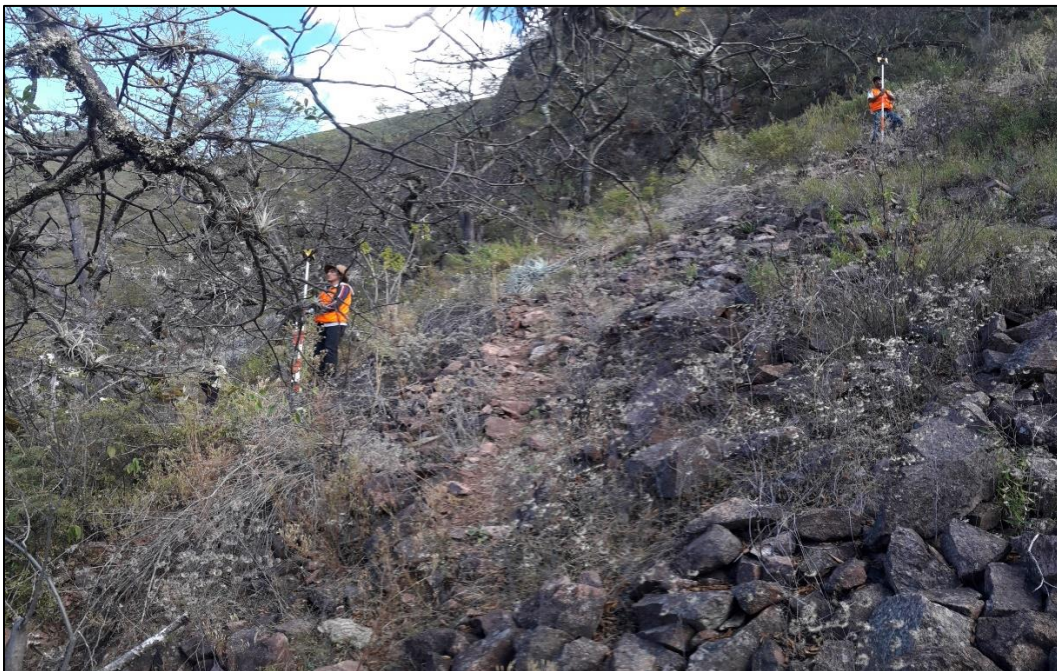
Fotografía 17: Vista de ubicación de los prismas en levantamiento topográfico
