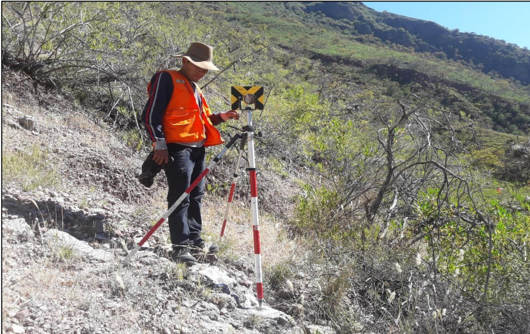
Fotografía 15: Colocación de puntos de apoyo
